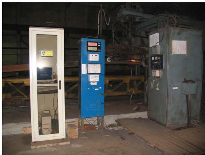
***Лабораторная версия компьютерного комплекса для управления технологическим процессом дифференцированного термического упрочнения***
