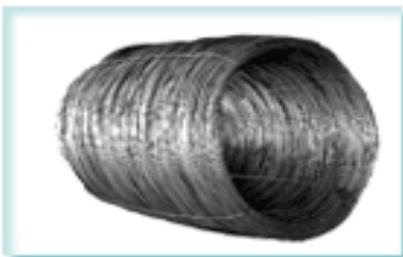
Анализ полученных механических свойств металла катанки показывает, что при использовании Нитрована возможно снижение содержания ванадия в стали без существенного ухудшения прочностных свойств металла.
