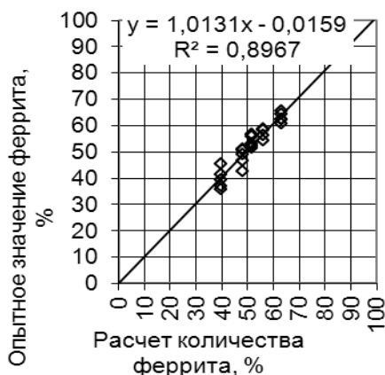
Рисунок 1- Точность расчета количества феррита деформированной стали UNS S31803(табл.2), отожженной при 1050С, 1150С, 1200С, 1150С+1050С, 1200С+1050С. Время отжига 7мин при каждой температуре.
