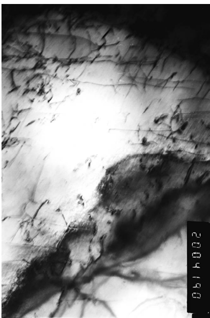
Рис. 3.9. Тонка структура центральної зони вихідної заготовки сталі 08 пс: а, в, г – \times 20\,000 ; б – \times 30\,000
