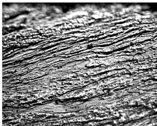
Рис. 7.6. Мікроструктура поперечного перетину зразка гарячекатаної сталі 08пс після додаткової деформації методом КГТ, N=5, d=9 мм a – загальний вид, \times 100 ; б-г – \times 400 ; д-е – \times 500
