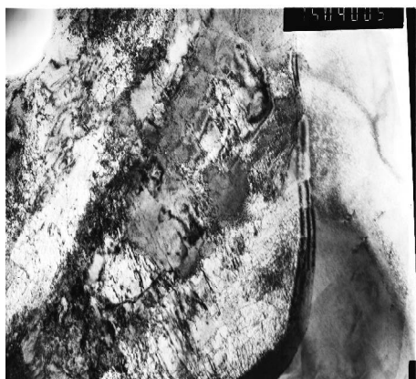
Рис. 3.8. Тонка структура поверхневої зони зразка сталі 08пс, деформованого в СКІТ: а – в, д – \times 15000 ; г – \times 20000 ; е – \times 38000
