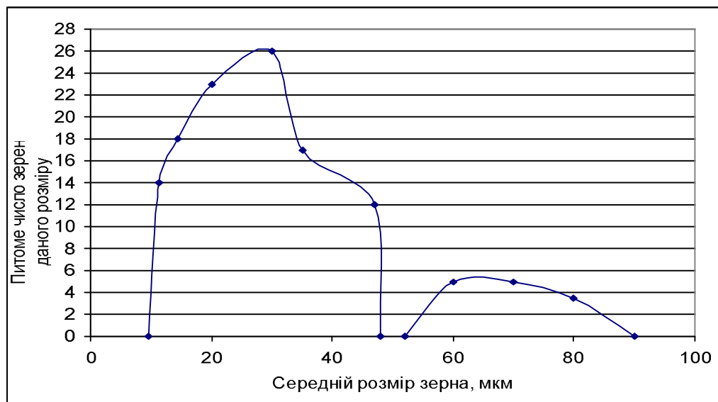
Рис. 4.3. Криві розподілу зерен в структурі поверхневого шару зразків сталі 08пс за розмірами: а – \Sigma\varepsilon = 26,1\% ; б – \Sigma\varepsilon = 27,0\% ; в – \Sigma\varepsilon = 22,2\% ; г – \Sigma\varepsilon = 16,4\% , T_{\text{зп}} = 500^\circ\text{C} ; д – \Sigma\varepsilon = 16,4\% , T_{\text{КП}} = 600^\circ\text{C}
