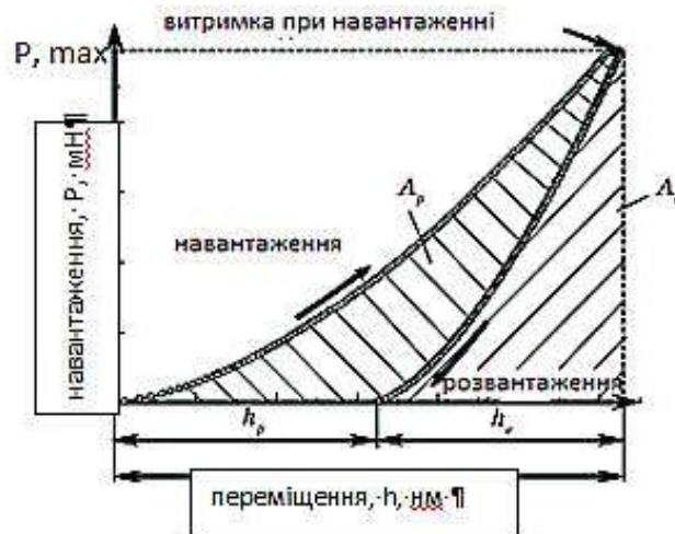
Рис. 9.21. Діаграма навантаження індентора Берковича в координатах навантаження та переміщення індентора [282]
