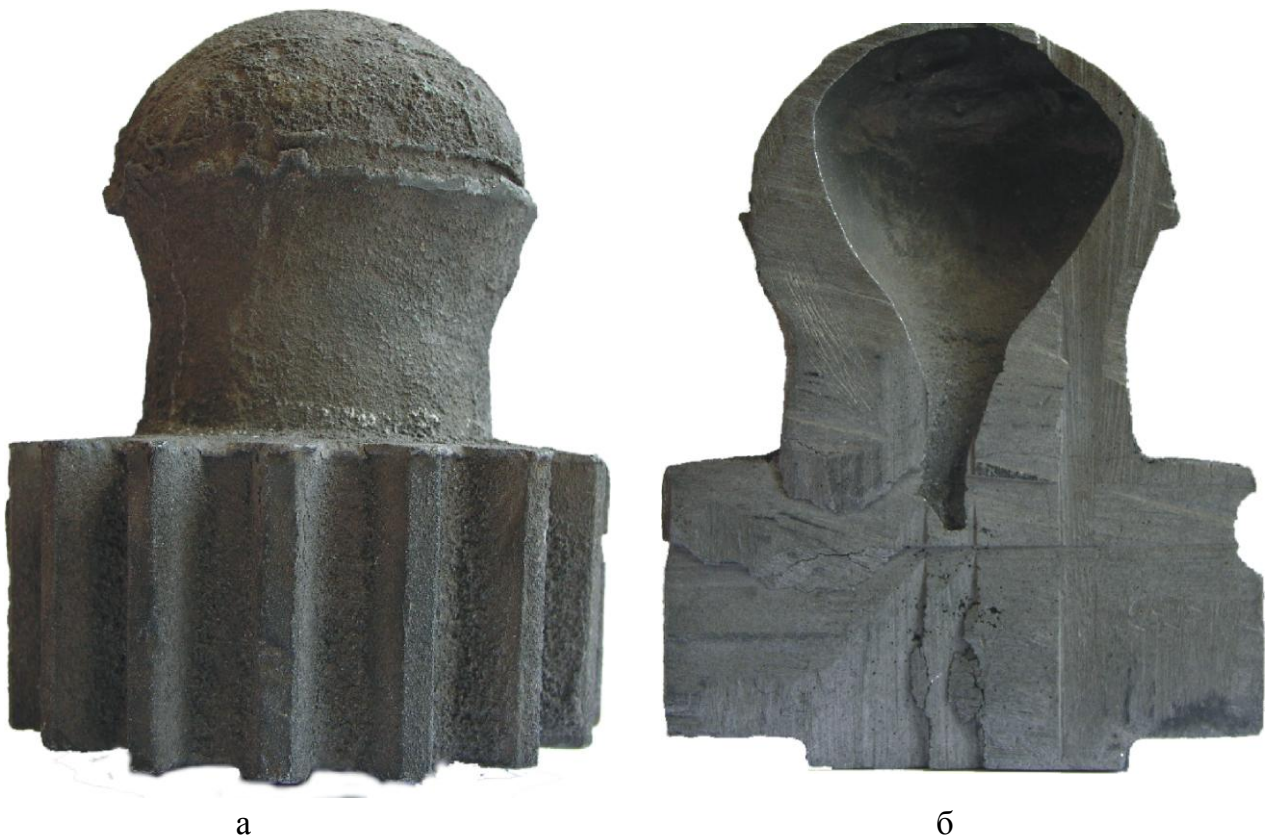
Рис. 6.7. Виливок «шестерня» (діаметр - 140 мм, висота - 65 мм, діаметр напівкульового надливу - 105 мм, його висота – 105 мм, загальна висота виливка - 178 мм. Матеріал – 30Л ГОСТ 977-88, маса чорнова – 3,5 кг):
