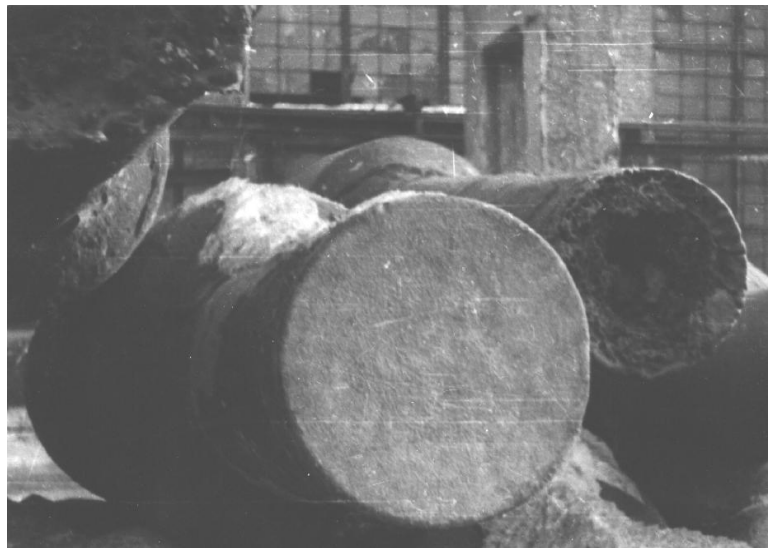
Рис. 10.5. Торець надливу виливка з високоміцного чавуну масою 26000 кг, відлитого з комбінованим електродуговим-електрошлаковим обігрівом і виливків, відлитих з утепленням деревним вугіллям і дворазовою доливкою надливу з додаткової печі
