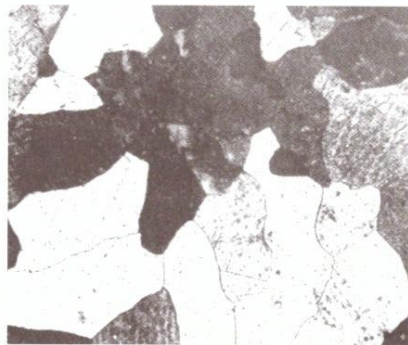
Рис. 3.9. Микроструктура литой меди, \times 100
