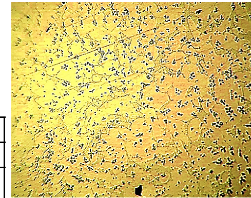
Рисунок 9 – Типова мікроструктура (×100) БрА9ЖЗЛ
