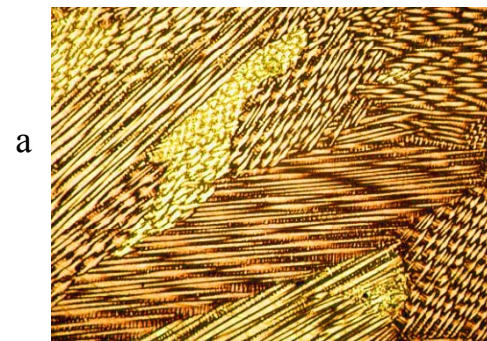
а – α - зерна з дендритною ліквідацією (×300), б – однорідний твердий розчин (×100)
