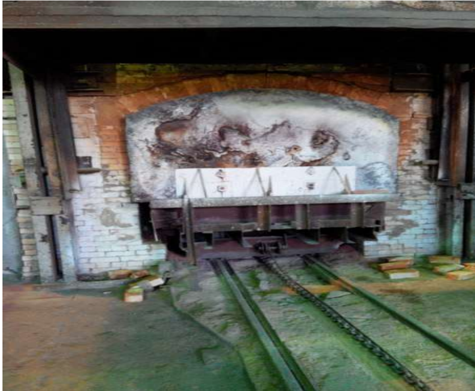
Рисунок 4.7 – Загальний вигляд камерної печі під час відпалу металу
