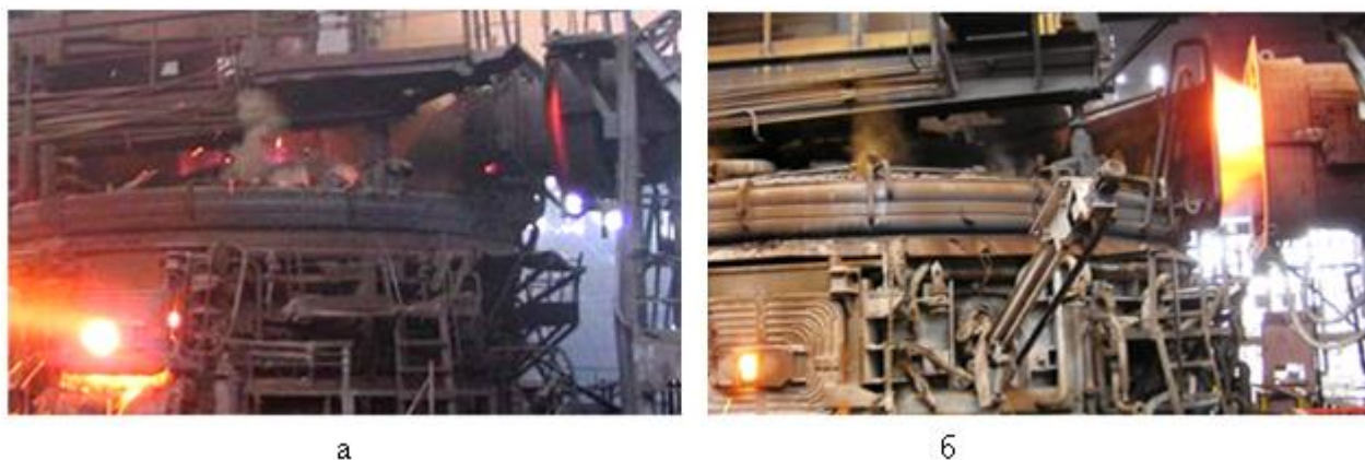
Рис.8.14–Неорганізовані викиди 125-т ДСП з традиційною системою газовидалення (а) і з системою розподіленої аспірації (б).
