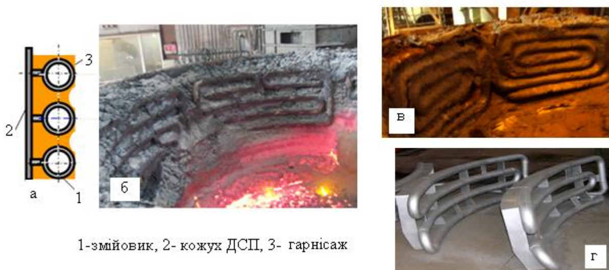
Рис. 8.6—Однорядні водоохолоджувані панелі з нещільною структурою: схема (а), вид в 12-т ДСП (б), вид в 25-т ДСП (в), загальний вигляд панелей (г).
