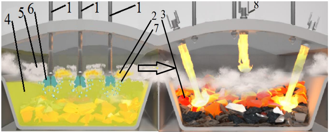
Рисунок 3.4 Загальна схема ДСА з факелом, що утворюються при продуванні ванни ( [C]=3\% з витратою кисню через кожну фурму 2000 \text{ м}^3/\text{год} : 1 – фурма; 2- факел; 3 – металобрухт; 4 – розплав; 5- потік, що зносить; 6- кисневий факел; 7-бульбашки \text{CO} ; 8 –газо-повітряний пальник
