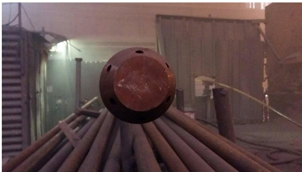
Рисунок 2.6 Фото накієчника дуттьового пристрою із соплами різного діаметра й різними кутами нахилу
