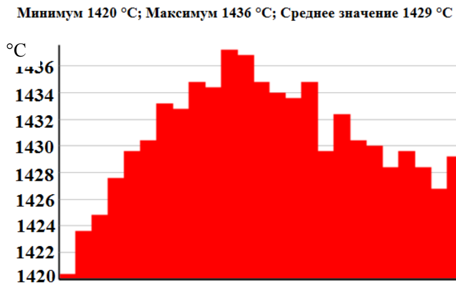
Рисунок 2.11 Термограма: базова фурма (кут нахилу сопел 30°)
