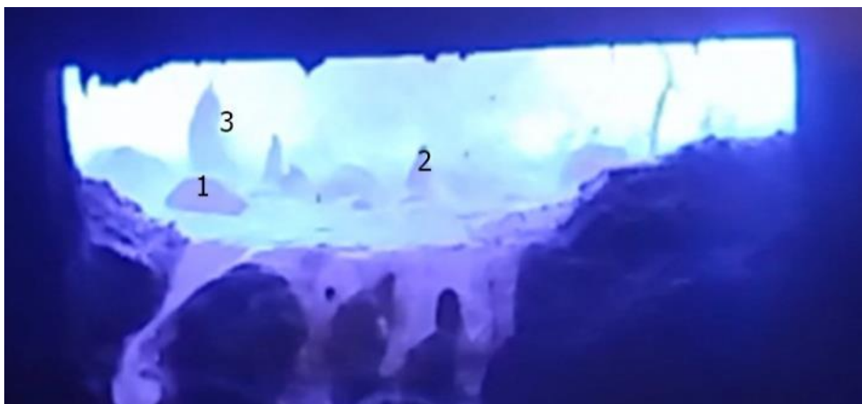
Рисунок 4.1 Процес руйнування бульбашки на поверхні розплаву: 1- бульбашка монооксида вуглецю (СО) на поверхні розплаву; 2, 3 – розрив бульбашок на поверхні розплаву
