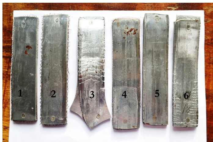
Рис. 3.3. Зразки сплаву EN AW -5056 при прокатці зі ступенем деформації 30%: 1) 5056-A-90-30; 2) 5056-A-45-30; 3) 5056-B-90-30; 4) 5056-B-45-30; 5) і 6) 5056-0-30 [101].
