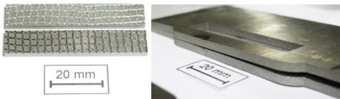
Рис.1.3. Зразок пресованого армованого композиту. Напруження при з'єднанні було 249 МПа.
