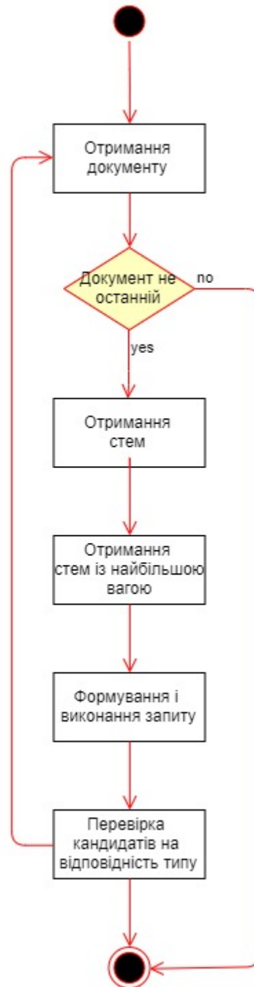
Рис. 3.15. Алгоритм роботи системи автоматичного тестування якості запитів
