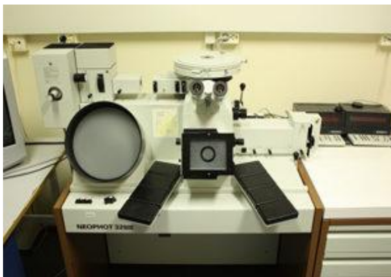
Рис. 2.3. Зовнішній вигляд металографічного мікроскопу «Neophot – 32» [38]
