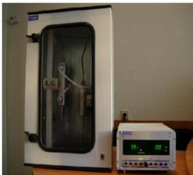
Рис. 2.13. Зовнішній вигляд ультразвукового диспергатора УЗД-22/44 [65].
