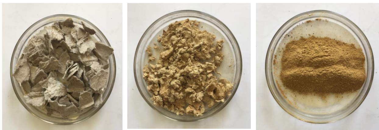
Рис. 5.37. Знімок ВЦ: а) до обробки; б) після обробки NaOH; в) після просушення та подрібнення.
