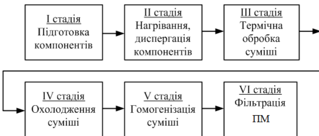
Рис. 5.1. Блок-схема процесу виробництва ПМ з вторинної сировини.
