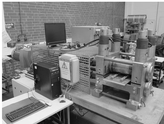
Рис. 2.12. Фотографія прокатного стана дуо кафедри матеріалознавства Падерборнського Університету (м.Падерборн, ФРН) зі встановленою системою гідромеханічного навантаження кліті [80]
