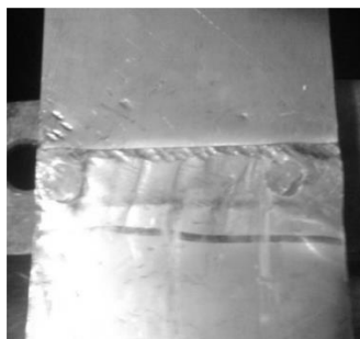
Рис. 4.2. З'єднання профільюючої стрічки з використанням замка та заклепок
