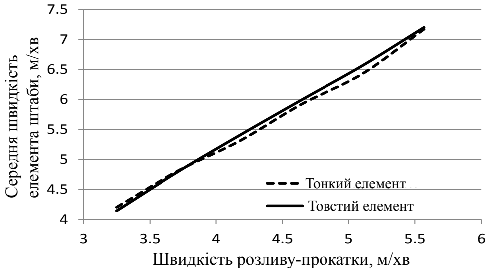
Рис. 3.7. Залежність середньої швидкості елемента профільованої штаби в площині виходу з валків-кристалізаторів від швидкості ведення процесу
