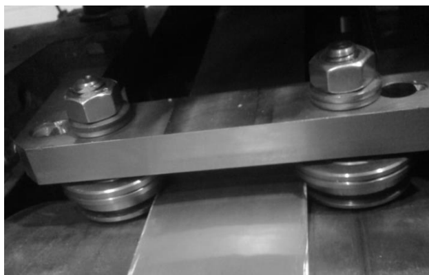
Рис. 4.3. Вертикальні профільовані ролики, що обмежують переміщення профільюючої стрічки уздовж бочки валка-кристалізатора
