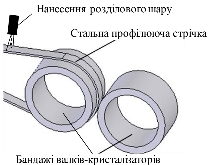
Рис. 2.1. Принципова схема запропонованого методу виготовлення штаб з профільованим поперечним перерізом на машинах валкового розливу-прокатки
