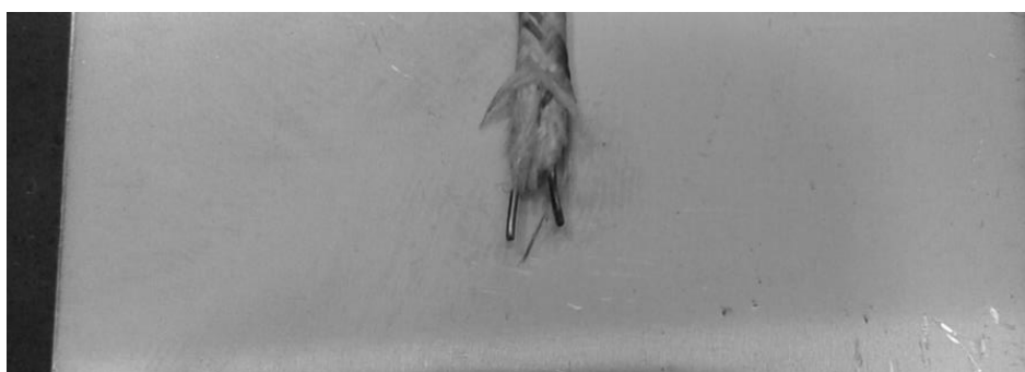
Рис. 4.9. Термоелемент на профілюючій стрічці для вимірювання температури тонкого елемента профільованої штаби
