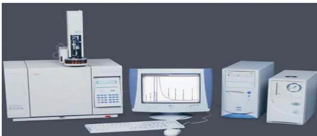
Рисунок 2.11 – Світлина газового хроматографа «Кристалл-2000»
