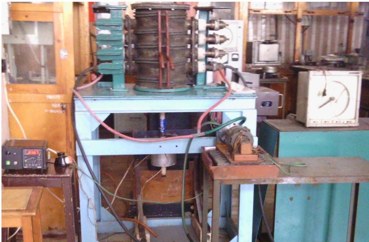
Рисунок 2.4 – Свiтлина двоступеневої лабораторної установки для газифiкацiї полiдисперсних систем кам'яновугiльного походження
