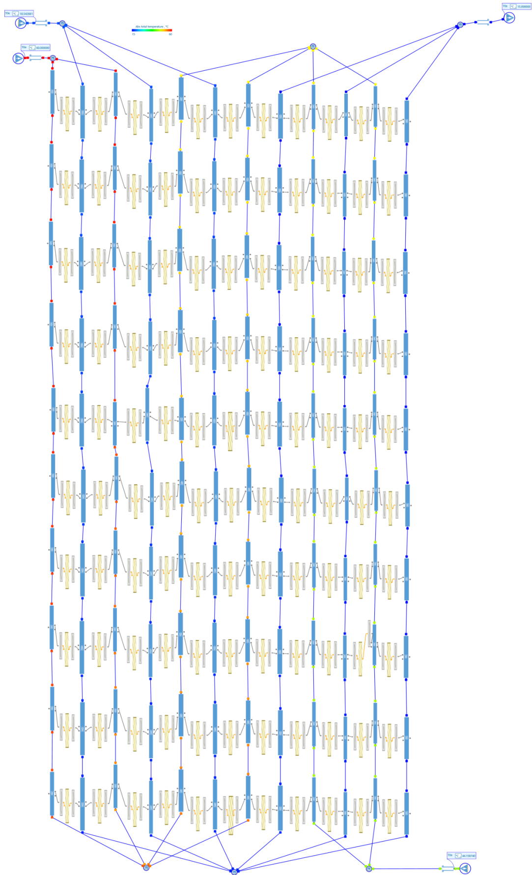
Рисунок 3.12 – Результати моделювання пластинчастого теплообмінника в 1Д солвері
