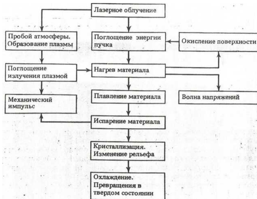
Рис. 1.1. Фізичні процеси, що протікають в матеріалах при лазерному опроміненні [6].
