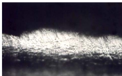
Рис. 5.6. Структура лазерно-загартованого шару після пластичної деформації в процесі зносу; x500
