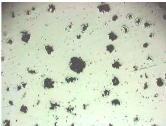
Рисунок 5.18 – Чавун с компактным графітом (×500)
