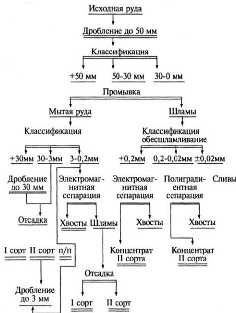
Рис. 1. Технологическая схема обогащения окисных марганцевых руд на ОГОКе [7]
