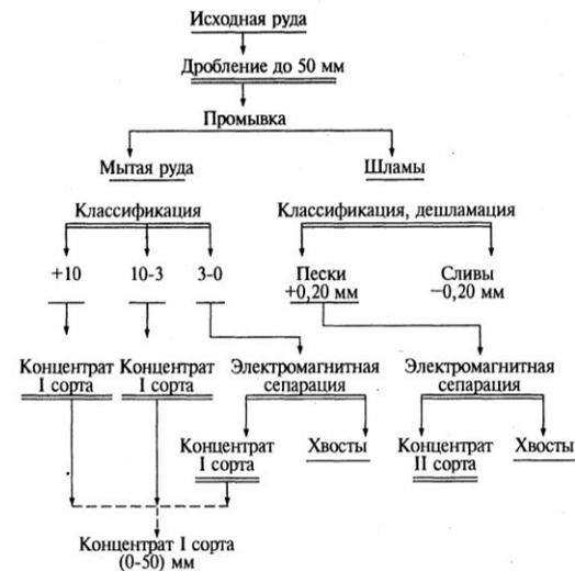
Рис. 2. Технологическая схема обогащения карбонатных марганцевых руд на ОГОКе [7]
