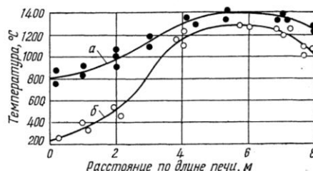
Распределение температуры отходящих газов (а) и материала (б) по длине вращающейся трубчатой печи
