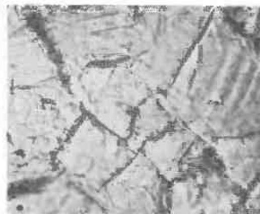
Рис. 3.5. Микроструктура аустенита (высокотемпературный микроскоп,  $\times 900$ )
