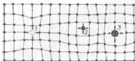
Рис. 1.7. Искажения кристаллической решетки вблизи точечных дефектов:
