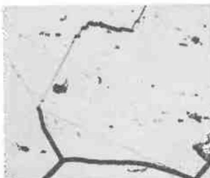
Рис. 1.27. Расщепление большеугловой границы в железном сплаве ( $\times 600$ , Н. В. Резник)
