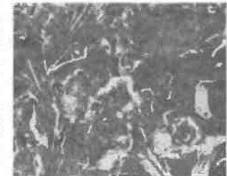
Рис. 2.45. Структура поверхности излома при хрупком сколе ( $\times 500$ )
