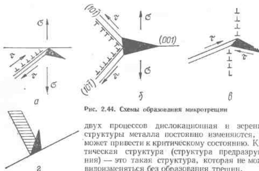
Рис. 2.44. Схемы образования микротрещин
