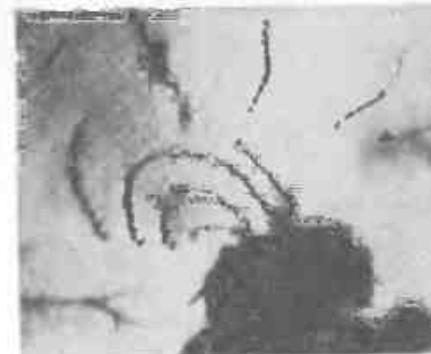
Рис. 1.18. Источник дислокаций в нержавеющей стали ( $\times 40\ 000$ )
