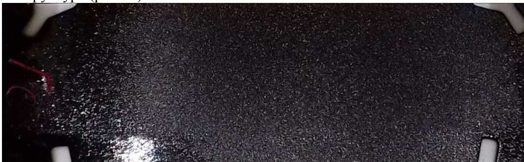
Рисунок 18 – Плівка заліза, нанесена на скляну підкладку при мінімальній швидкості випаровування
