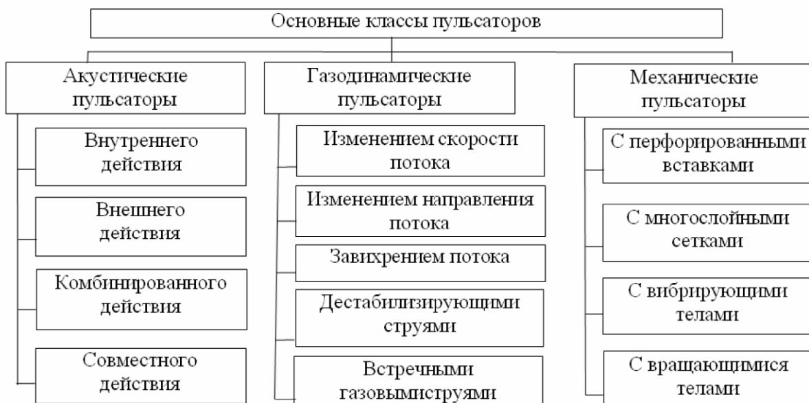
Рисунок 1 - Классификация устройств для возбуждения пульсаций.
