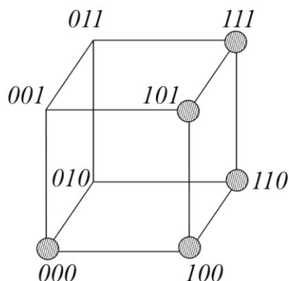
Рис. 9.1. Геометрическое представление (нулевые кубы) булевой функции
