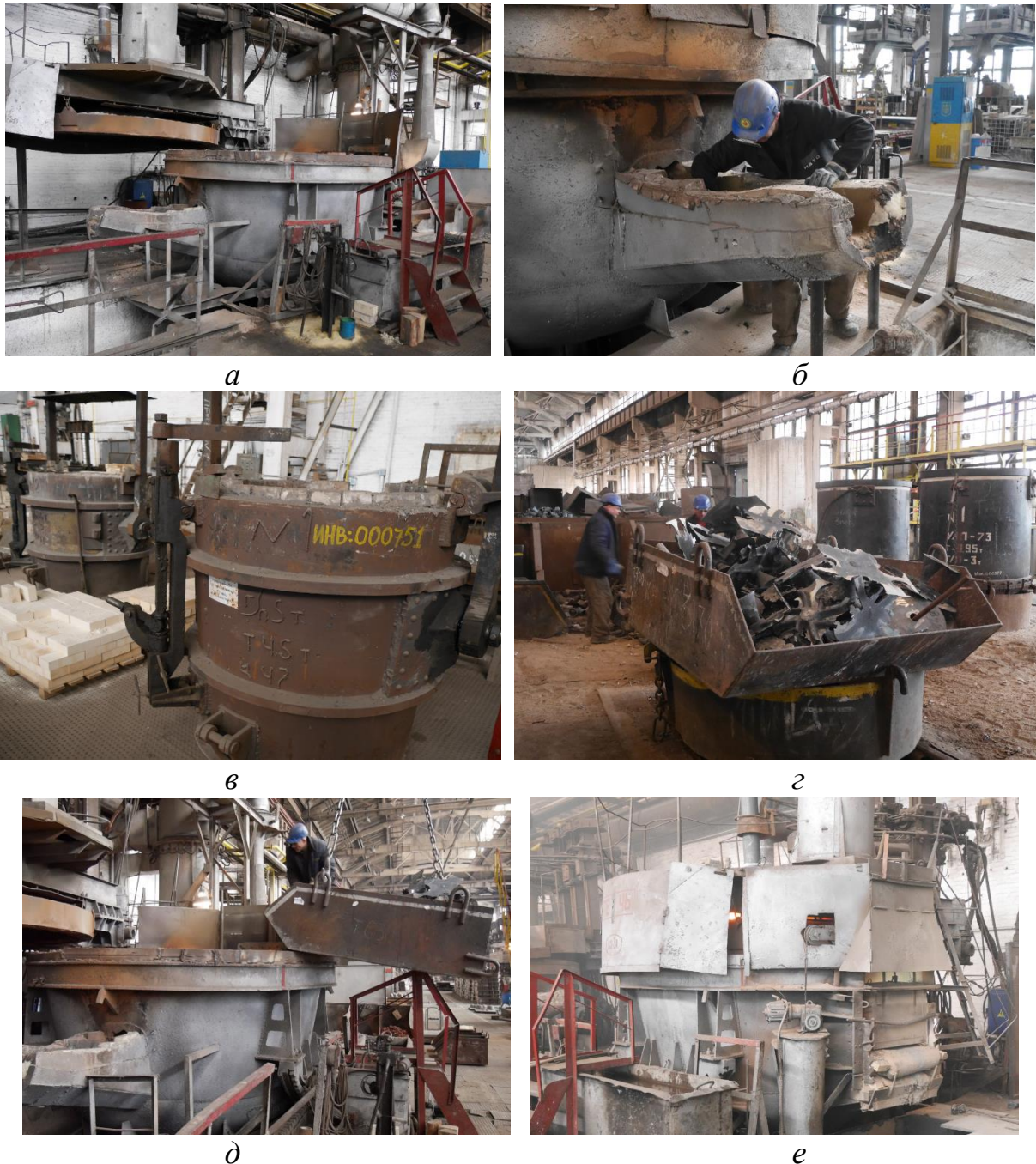
Рис. 1. Фрагменти відео про підготовку печі (а, б) та деякого обладнання (в), зважування шихти (г) та її завантаження (д) для подальшої виплавки сталі (е)
