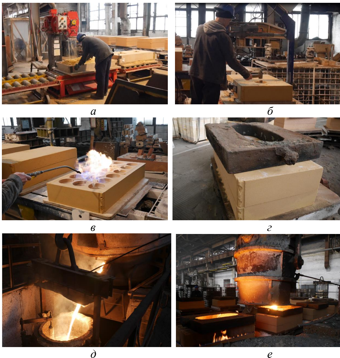
Рис. 2. Фрагменти відео, відзнятого на ділянці підготовки ливарних форм з використанням ХТС (а-г) для подальшої розливки сталі, яка була виплавлена і вилита з ДСП у ківш для розливки (д, е)
