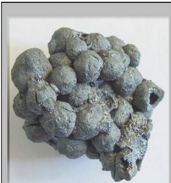
Рис. 2 - Опытно-промышленный образец нового окускованного железорудного материала
