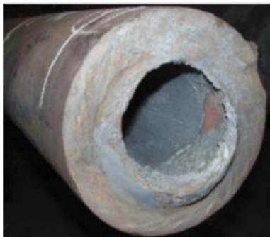
Рисунок 5. – Труба D x S = 203 x 45 мм після прокатування на пілігримовому стані: а – задній кінець, б – передній кінець
