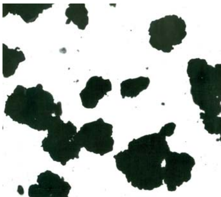
Рис. 1 – Оксид кальция под микроскопом в проходящем свете ( \times 200 , порошок)
