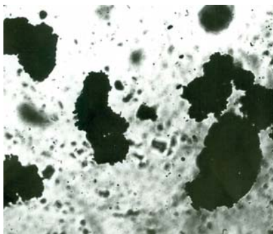
Рис. 3 – Карбонат кальция после измельчения под микроскопом в проходящем свете ( \times 200 , порошок)
