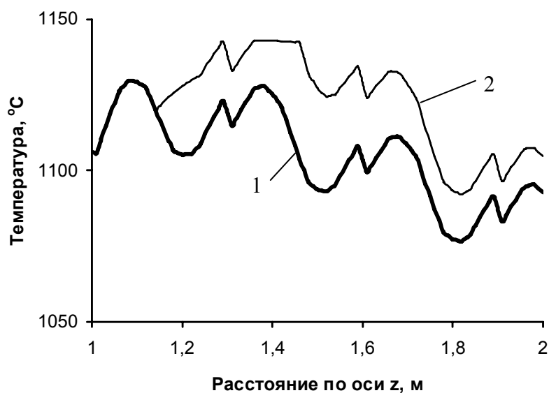
Рис. 5. Изменение температуры поверхности слитка на начальном участке ЗВО: 1 – нормальная работа форсунок, 2 – форсунки 1 и 2 орошают 50% поверхности
