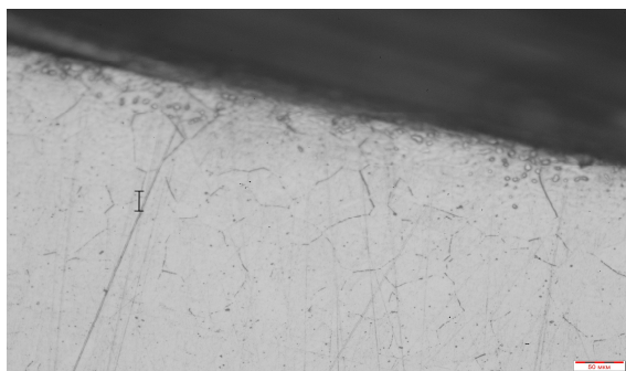
Рис. 1. Ступінчаста структура сталі 1.4466 (x200)
