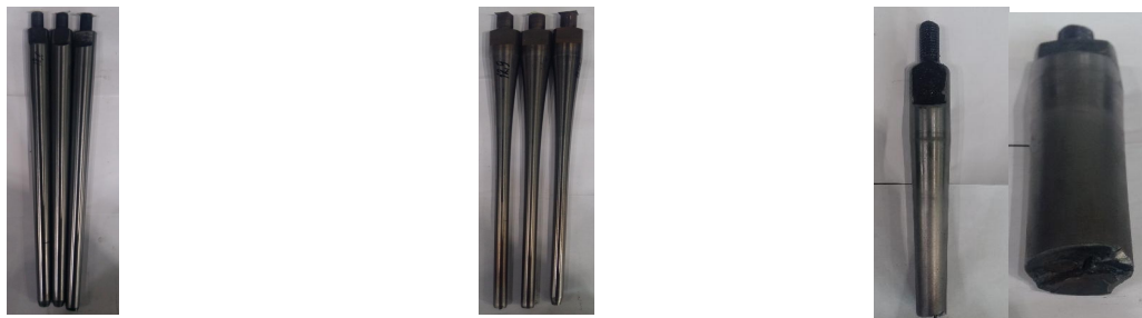
Рис. 1. Конічні (1) і криволінійні (2) оправки і їх характерний злам (3)
