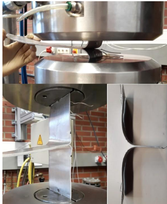
Рис. 1. Випробування на відшаровування-розтягнення
