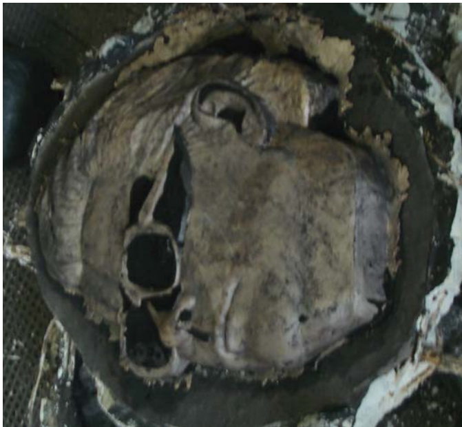
Рисунок 3.18 – Художній виливок із сплаву БрО5Ц5С5 після розкриття форми (без оброблення)
