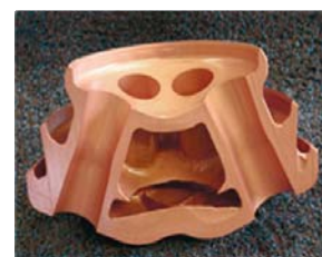
Рис. 2. Конструкция наконечника фирмы «Impact GmbH»: 1 - литой сопловой блок; 2 - соединительная вставка с наружной трубой отвода воды; 3 - соединительная вставка с промежуточной трубой подвода воды; 4 - соединительная вставка с центральной трубой подвода кислорода
