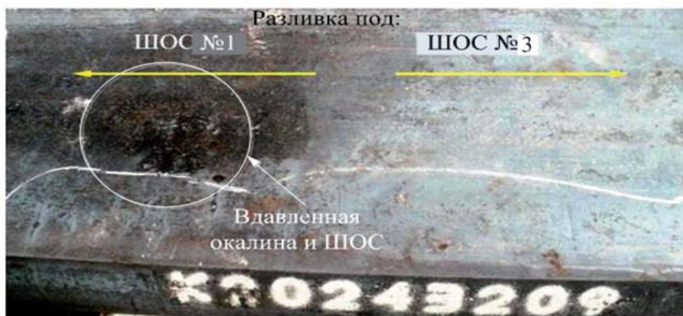
Рис. 4. Фрагмент поверхности сляба марки 09Г2С при разливке которого была произведена замена ШОС № 1 на ШОС № 3
