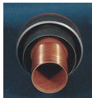
Рис. 1. Конструкция наконечника фирмы «Saar Metall»: 1 - нижняя штампованная чаша; 2 - водяной отражатель; 3 - сопловые вставки; 4 - верхняя чаша; 5 - соединительная вставка с наружной трубой отвода воды; 6 - соединительная вставка с промежуточной трубой подвода воды; 7 - соединительная вставка с центральной трубой подвода кислорода
