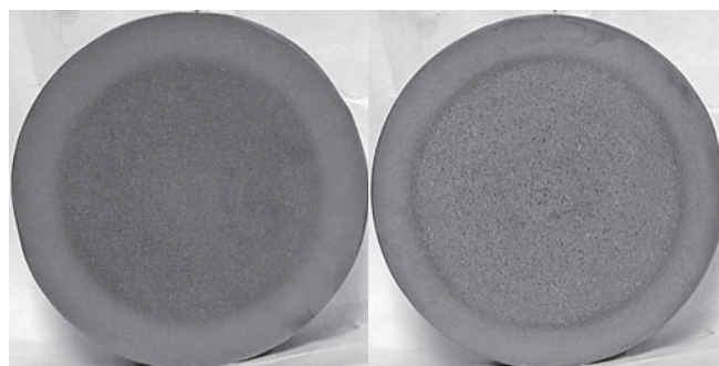
Рис. 2. Макроструктура опытных шаров диаметром 100 мм 3-й группы из стали с повышенным содержанием углерода
