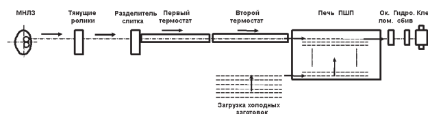
Рис. 2. Модернизированная схема технологической линии: стрелками показаны направления движения заготовок
