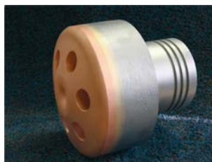
Рис. 2. Конструкция наконечника фирмы «Impact GmbH»: 1 - литой сопловой блок; 2 - соединительная вставка с наружной трубой отвода воды; 3 - соединительная вставка с промежуточной трубой подвода воды; 4 - соединительная вставка с центральной трубой подвода кислорода
