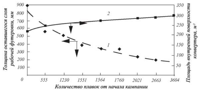
Рисунок. Динамика износа футеровки и изменение площади внутренней поверхности по ходу кампании: 1 – толщина остаточного рабочего слоя футеровки конвертера; 2 – площадь внутренней поверхности конвертера
