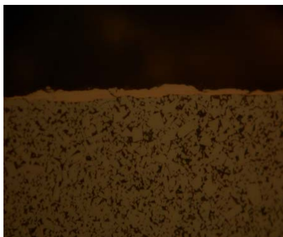
Рис.3. Микроструктура сплава ВК10 с TiZrN ионно-плазменным покрытием x 500
