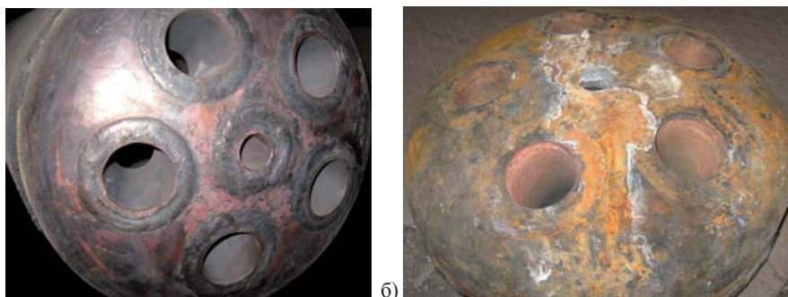
Рис. 1. Наконечник кислородной фурмы модернизированной конструкции: а) – после установки на фурменный ствол № 5; б) – снятый с фурмы после 329 плавов
