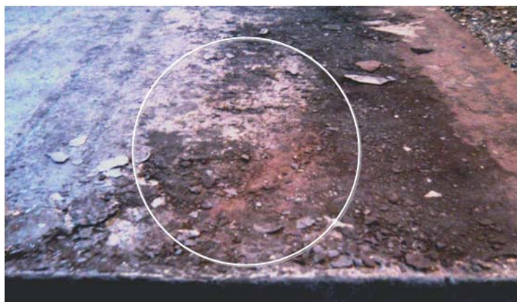
Рис. 1. Поверхность сляба из стали марки C091TM запрессованными участками скоплений окалины и шлака
