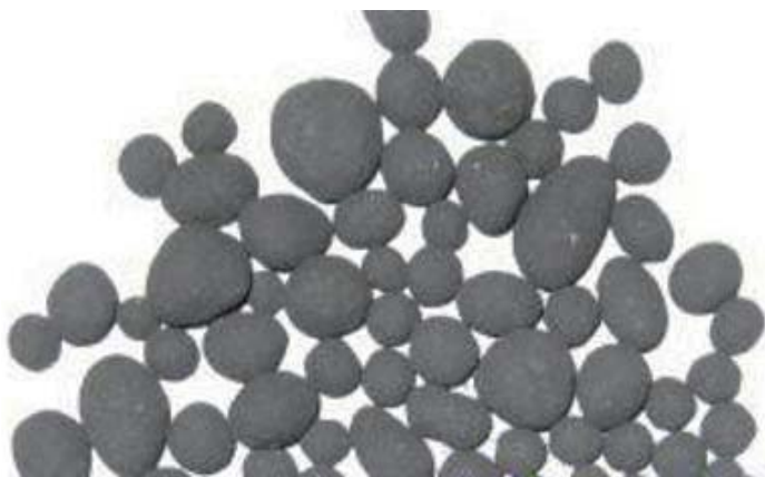
Рис. 3. Гранулы, образованные концентратом с обогащенной окалиной
