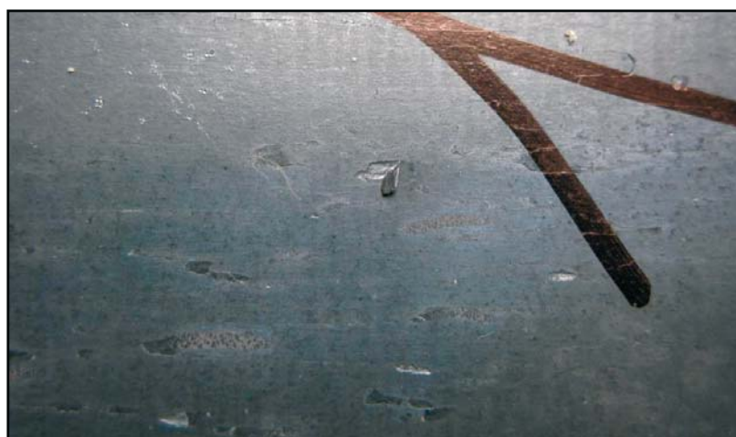
Рис. 3. Внешний вид дефекта на верхней поверхности г/к проката
