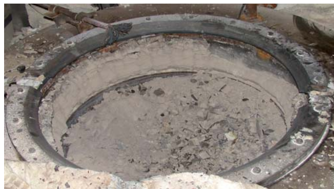
Рисунок. Внешний вид остывшего шлака в кристаллизаторе диаметром 920 мм после выплавки слитка
