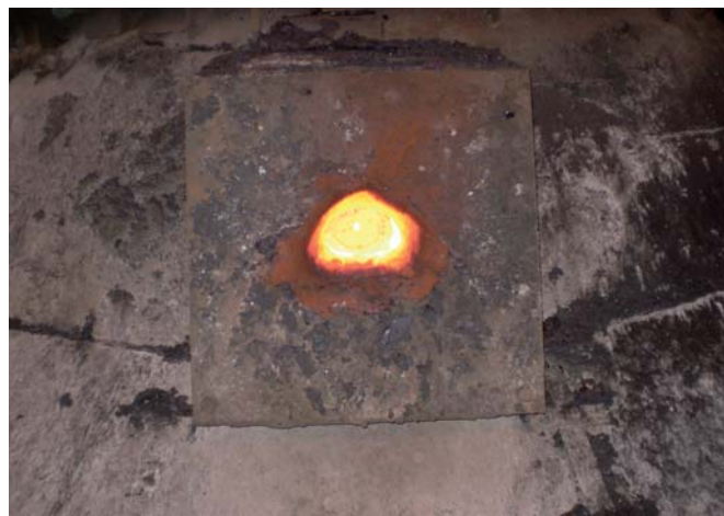
Рис. 2. Установленная в лётке пробка
