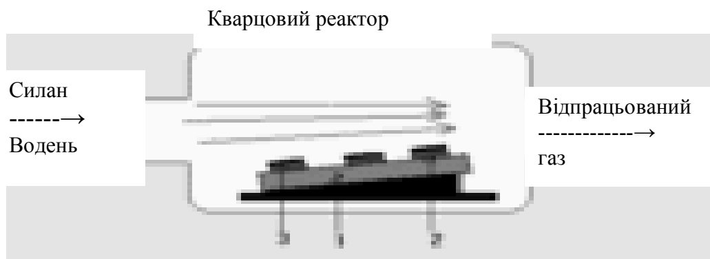
Рис. 7.10. Схема реактора для епітаксії з паро-газової суміші: 1- тримач; 2- кремнієва пластина; 3- плівка
