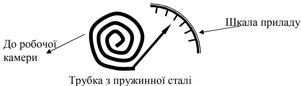
Рис. 3.10. Схема манометричного способу вимірювання вакууму
