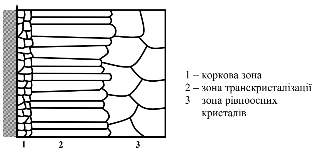
Рис. 7.29. Формування структури тонкої плівки залежно від швидкості тепловідводу
