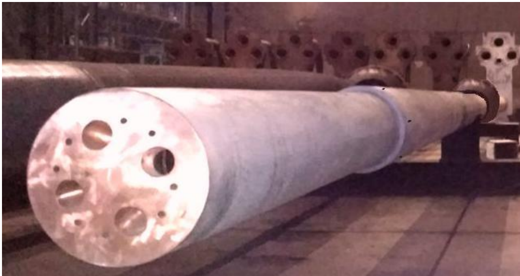
Рис. 1 – Прогрессивная конструкция двухъярусной кислородной фурмы
