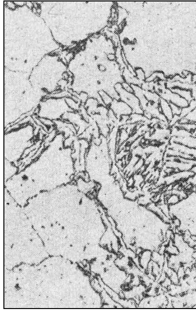
Рисунок 8.3 – \sigma -фаза в структурі жароміцної сталі
