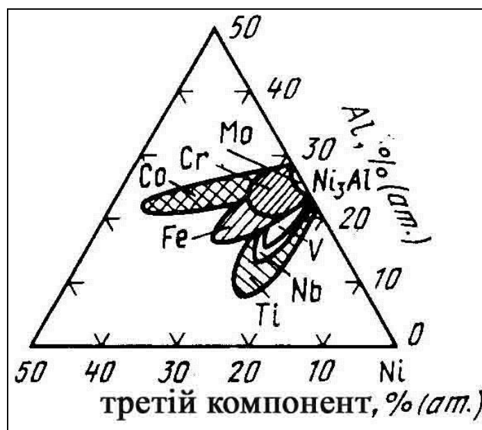
Рисунок 8.16 – Області твердого розчину на основі фази \text{Ni}_3\text{Al} при 1100^\circ\text{C} для різних легуючих елементів (Р.Декер)
