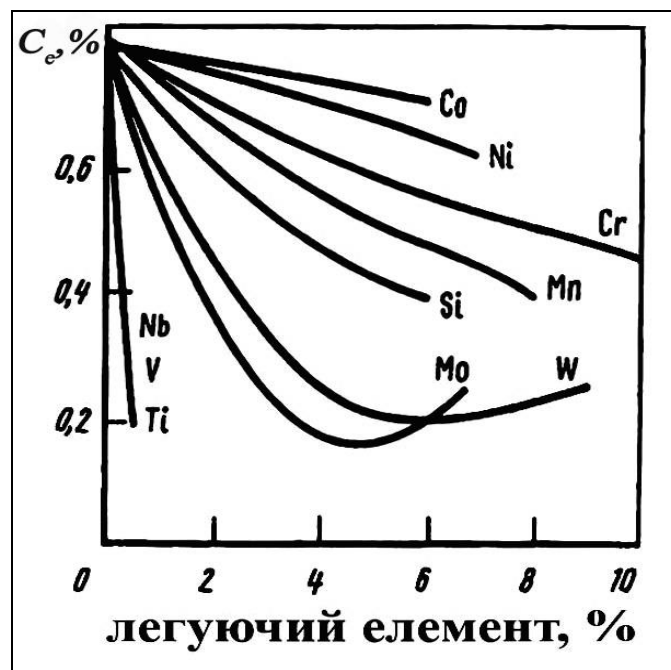
Рисунок 1.3 – Вплив легування на вміст вуглецю в евтектоїді ( C_E )
