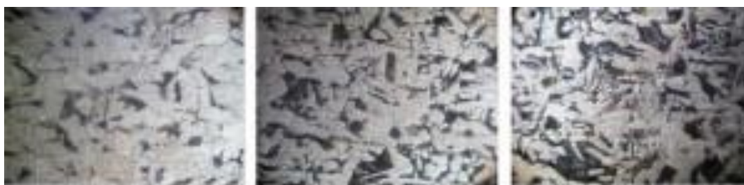
Рис. 6. Неоднородная структура исходного металла стали Ст20 в состоянии поставки (зона захвата), содержащего 8-10% (а), 18-20% (б) и 20-25% (в) перлита соответственно. Травление 4%-ным раствором HNO_3 , ×1000
