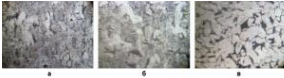
Рис. 7. Неоднородная структура исходного металла стали Ст20 в доле-вом направлении после деформации, содержащего 5-8% (а), 8-10%) (б) и 10-12%) (в) перлита соответственно. Травление 4%-ным раствором \text{HNO}_3 , \times 1000
