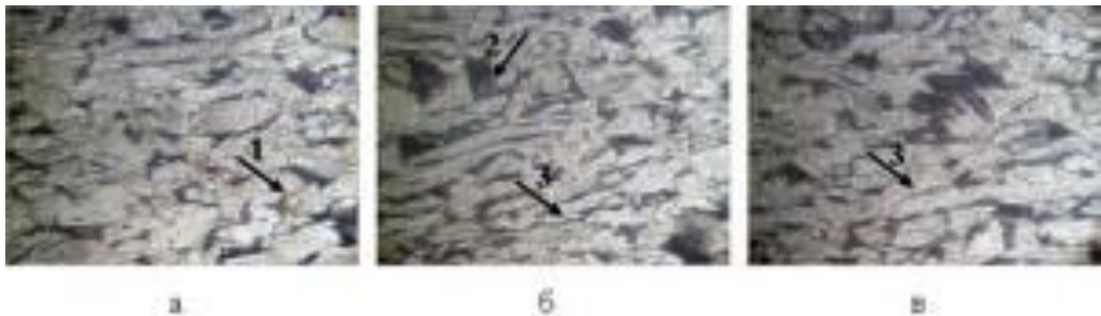
Рис. 8. Неоднородная структура металла стали Ст20 в поперечном на-правлении после деформации, содержащего 8-10% (а), 12-14% (б) и 15-17%) (в) перлита соответственно. Травление 4%-ным раствором \text{HNO}_3 , \times 1000 (1 — неметаллические включения; 2 — перлит; 3 — полоса дефектов)
