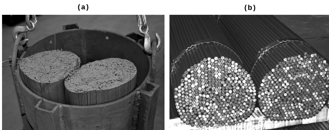
Rys. 1. Wiązki prętów stalowych: a) wsad wprowadzany do pieca w specjalnym koszu; b) zdjęcie ukazujące ziarnistą strukturę wiązek
