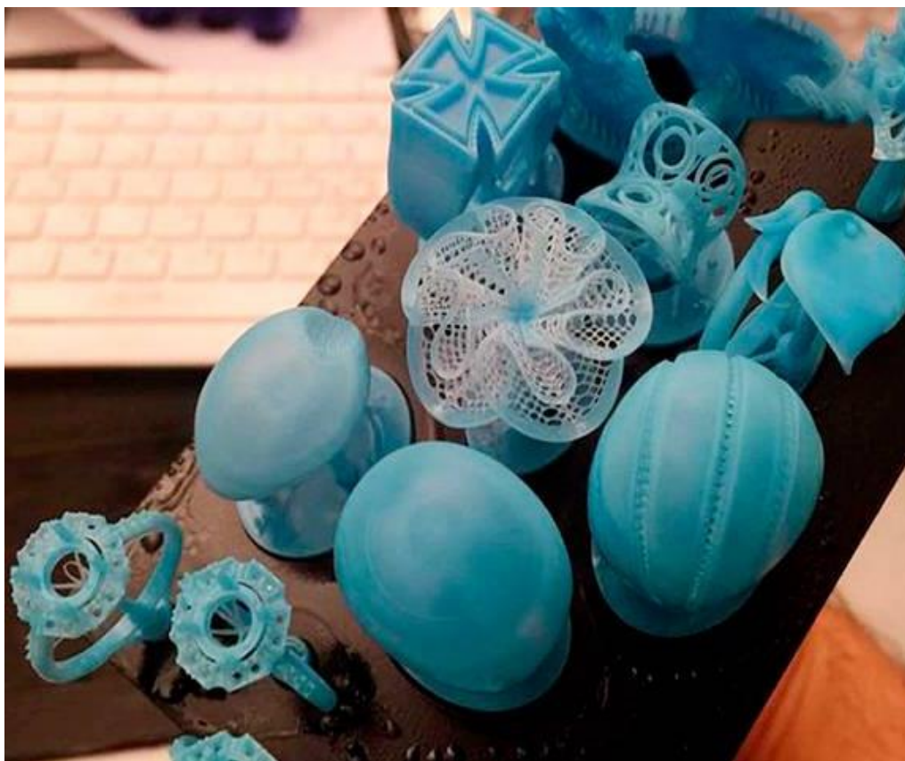
3D принтер SLA WANHAO DUPLICATOR 7 та приклади роздрукованих ливарних моделей, ауд. А507
