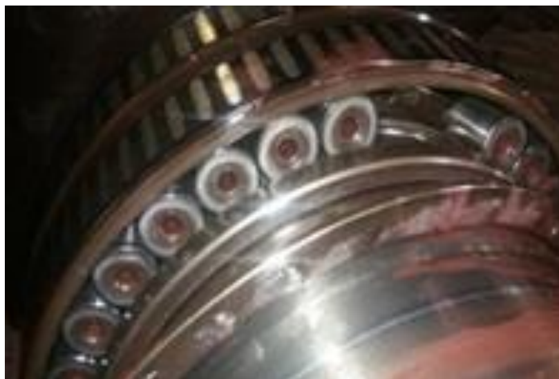
Рисунок 5.45 – Руйнування тіл кочення підшипника
