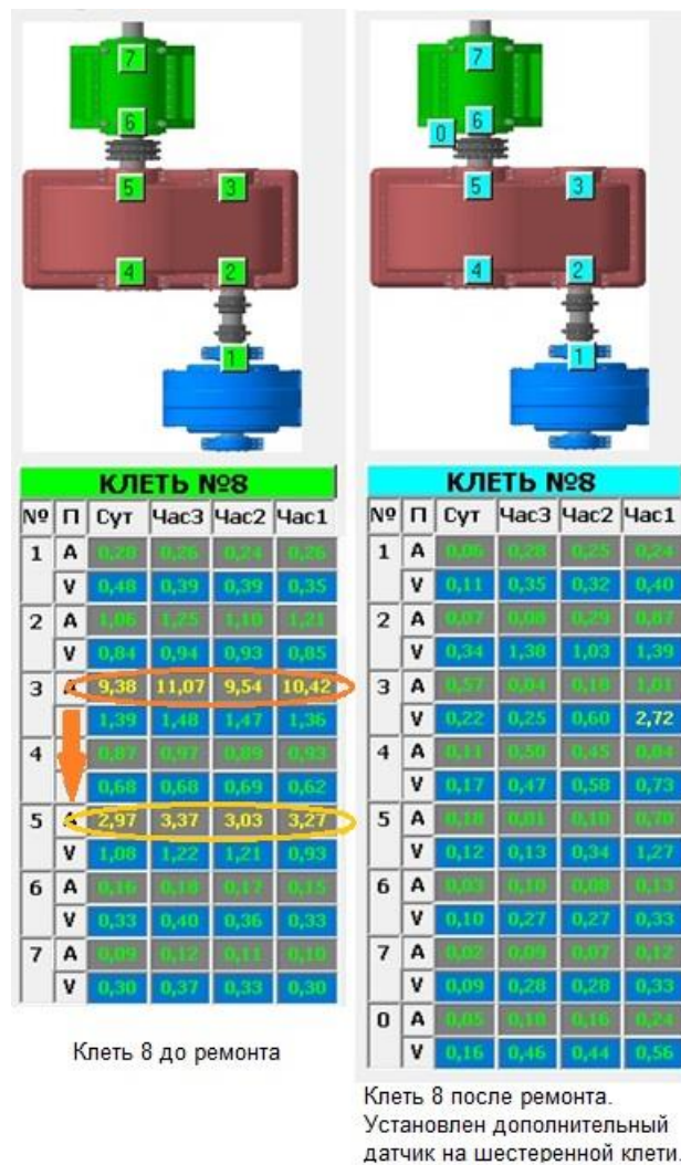
Рисунок 5.23 – Відображення вібраційного стану вузлів кліті №8. Підшипник № 3 (серії 97773) - зростання віброприскорення та його вплив на суміжний підшипник № 5 (вказано стрілкою) [77].
