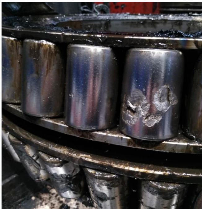
Рисунок 5.39 – Деформація та відколи на тілах кочення підшипника
