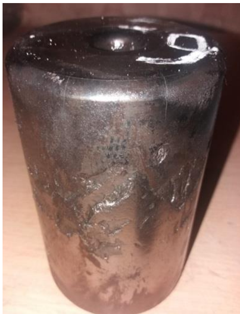
Рисунок 5.33 – Деформація та відколи на тілах кочення
