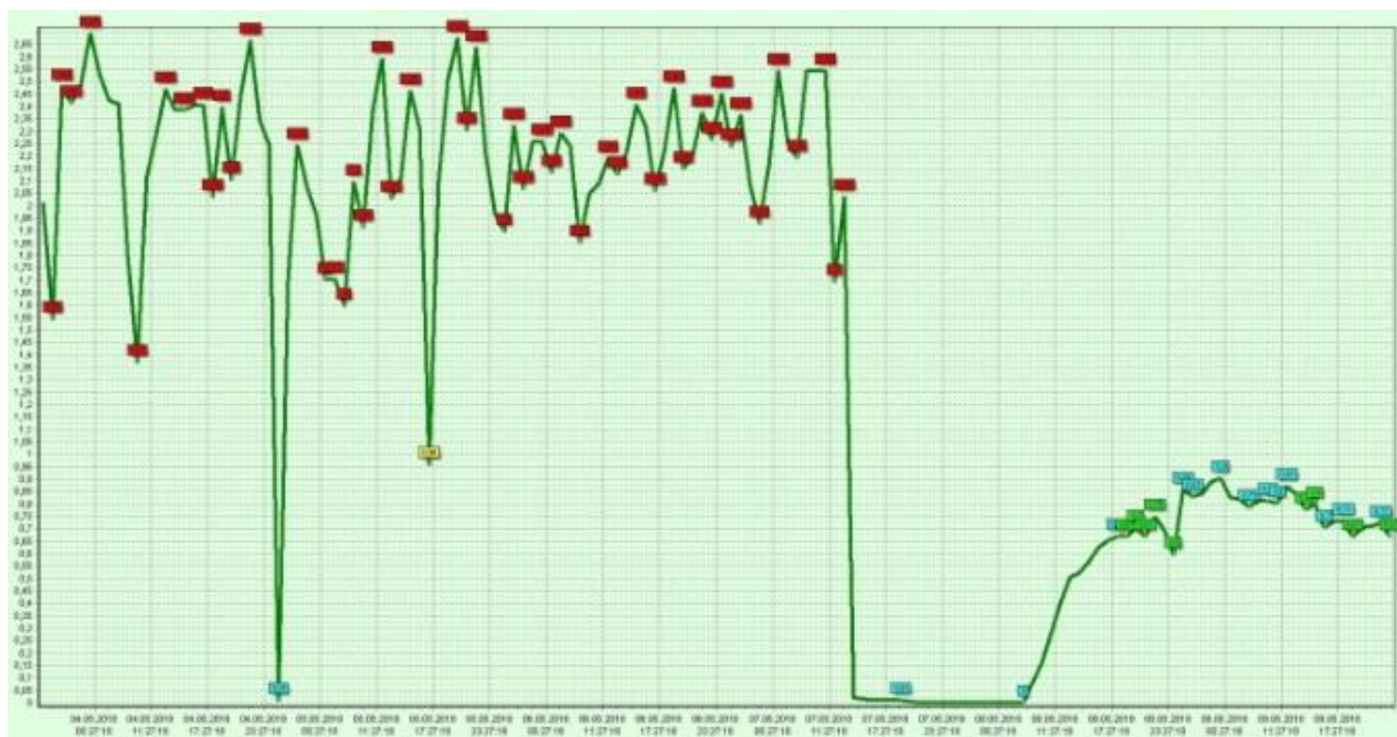
Рисунок 5.30 – Тренд віброприскорення підшипника № 4 до і після ремонту. Кліть № 4
