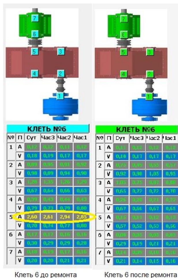
Рисунок 5.27 – Вібраційний стан вузла підшипника № 5, (ОУ: >2,2 \text{ м/с}^2 , пік), вимагає вжиття заходів. Кліть № 6.
