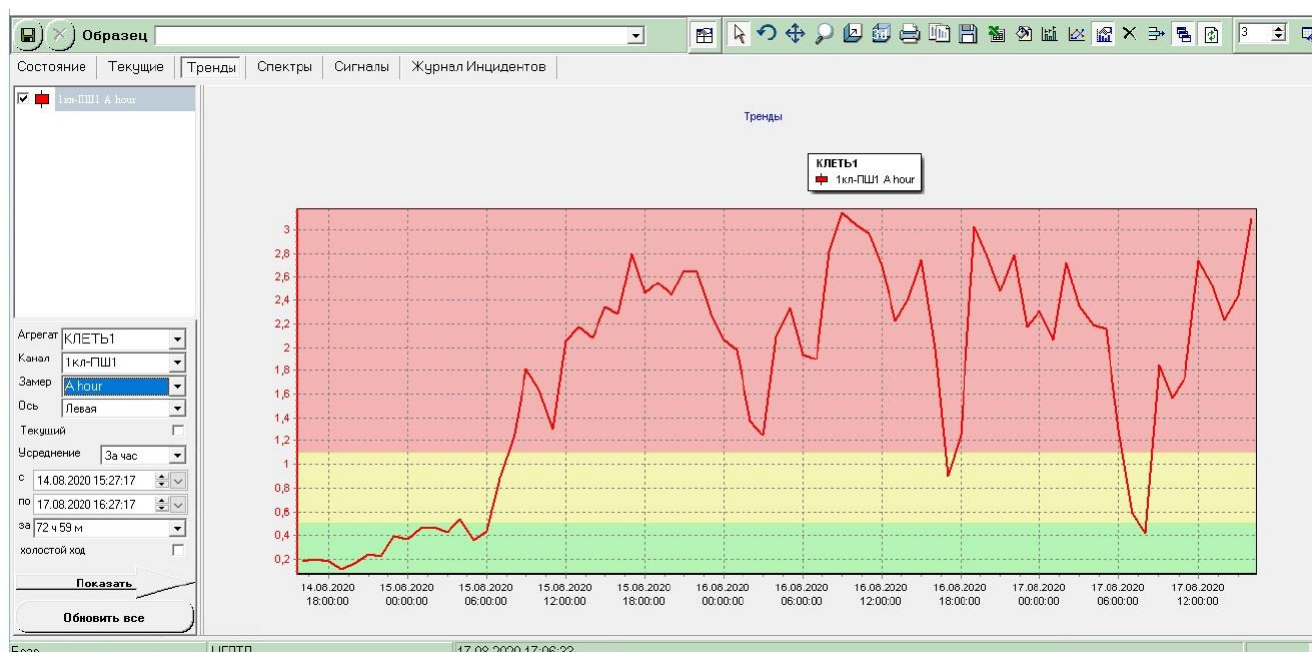
Рисунок 5.42 – Тренд вібрації дефектного підшипника
