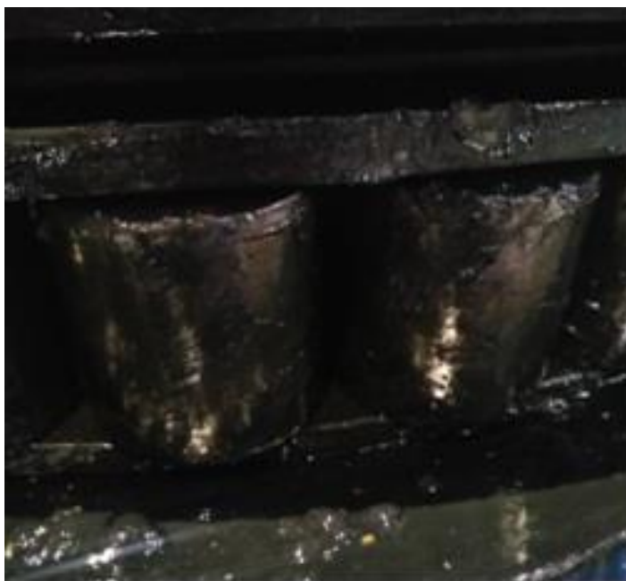
Рисунок 5.43 – Деформація та відколи на тілах кочення
