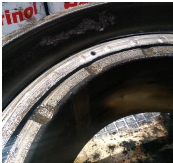
Рисунок 5.35 – Деформація та відколи на зовнішньому кільці підшипника
