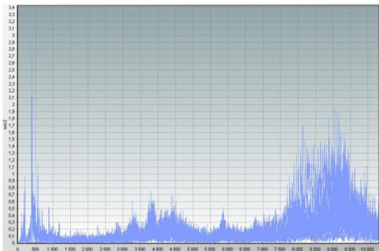
Рисунок 5.24 - Спектр віброприскорення підшипника № 3 кліті 8 до ремонту
