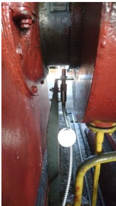
Рисунок 5.4 – Датчик обертів змонтований на спеціальному кронштейні
