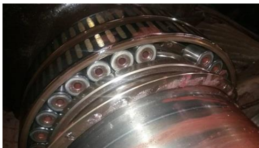
Рисунок 5.25 – Підшипник серії 97773: пошкодження внутрішнього дистанційного кільця; кліть № 8
