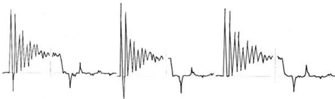
Рисунок 2.12 – Зворотні удари на проміжному валу при захопленні і викиді смуги. Кліть № 5, стан 1700 ПАТ «АрселорМіттал Теміртау»
