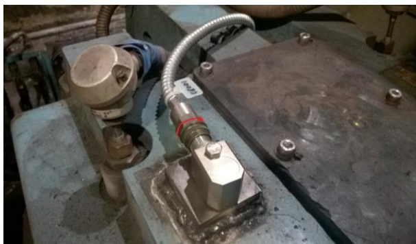
Рисунок 5.2 – Монтаж датчика вібрації АС104-3С
