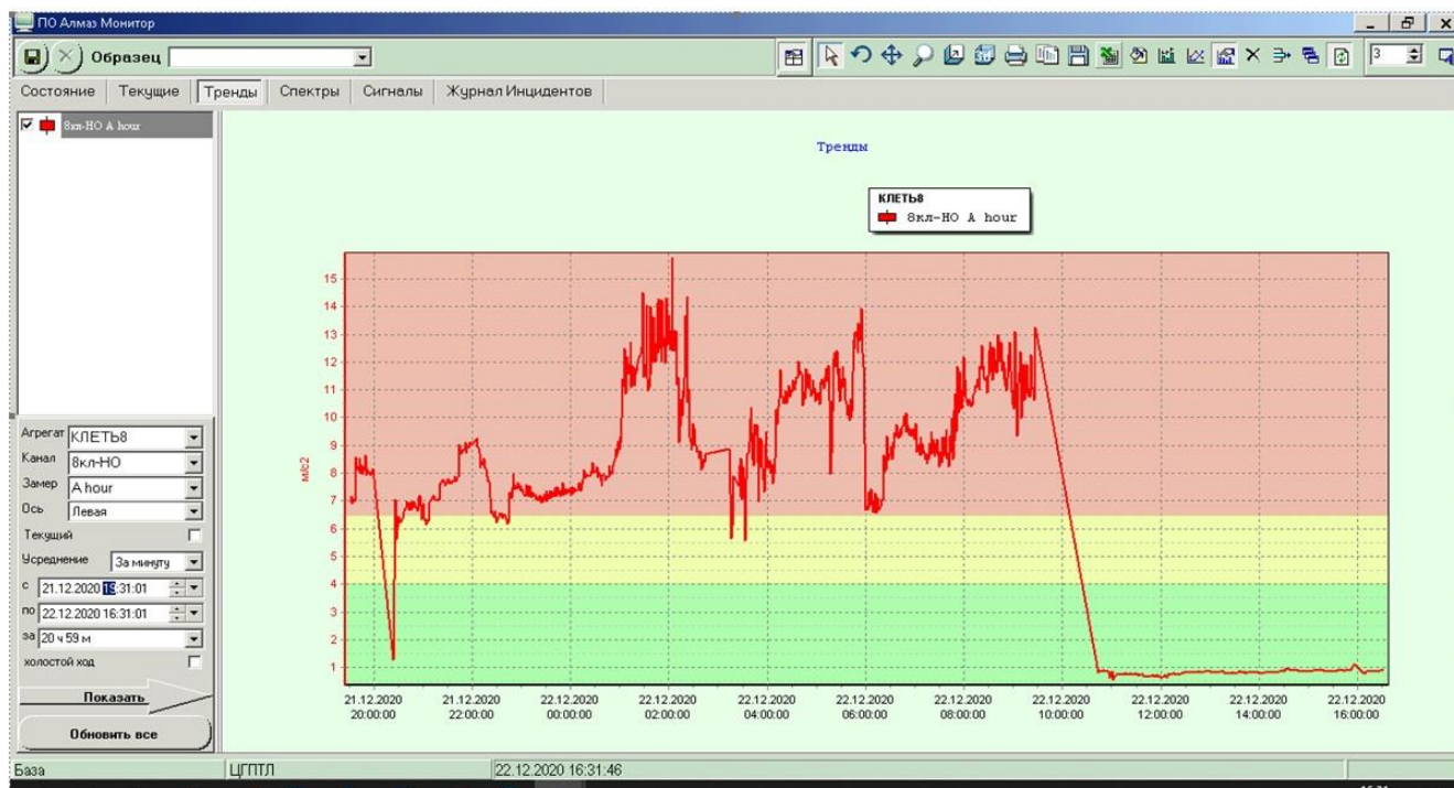
Рисунок 5.46 – Тренд вібрації до та після перевалки опорних валків
