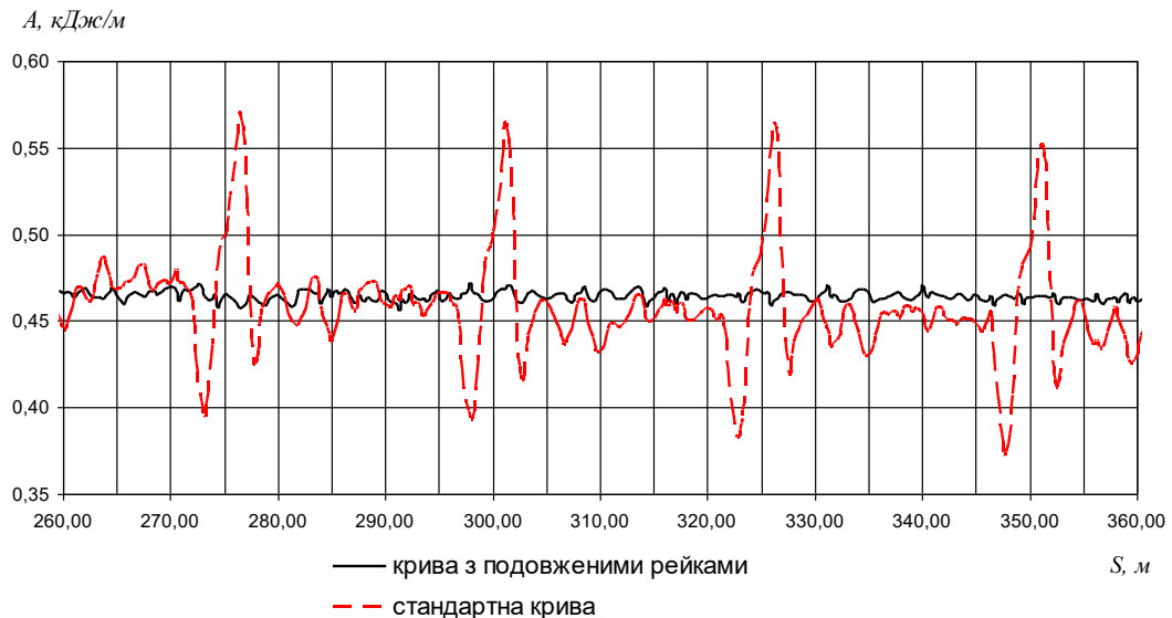
Рисунок 4.6 – Залежність показника інтенсивності зносу бічною поверхні рейки (питомої роботи сил тертя) від пройденого шляху при русі навантаженого вагона по кривій радіуса 275 м з довгими та стандартними рейками
