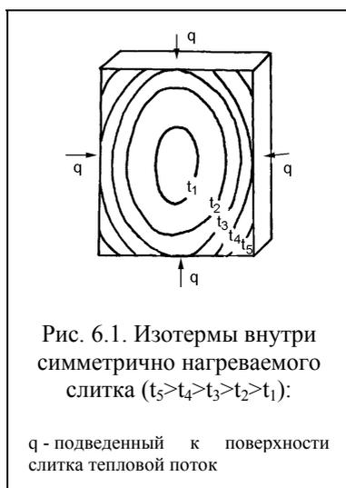
Рис. 6.1. Изотермы внутри симметрично нагреваемого слитка ( $t_5 > t_4 > t_3 > t_2 > t_1$ ):
