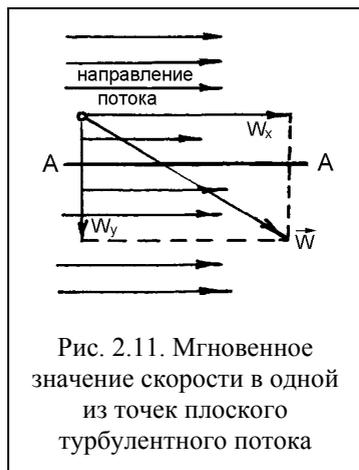
Рис. 2.11. Мгновенное значение скорости в одной из точек плоского турбулентного потока
