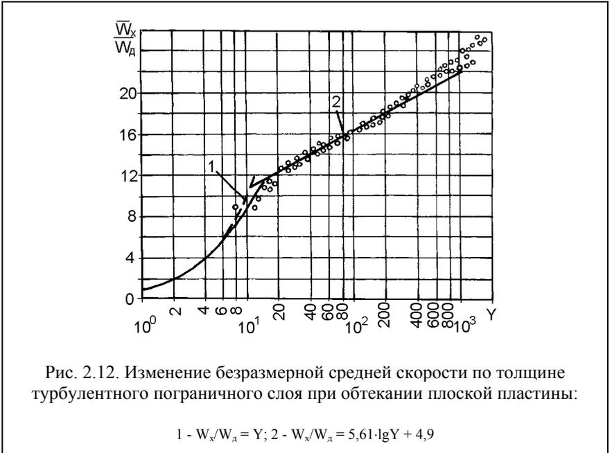
Рис. 2.12. Изменение безразмерной средней скорости по толщине турбулентного пограничного слоя при обтекании плоской пластины:
