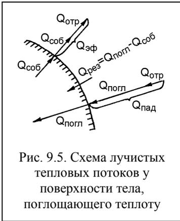
Рис. 9.5. Схема лучистых тепловых потоков у поверхности тела, поглощающего теплоту
