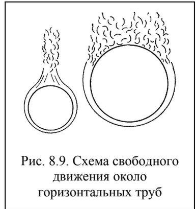
Рис. 8.9. Схема свободного движения около горизонтальных труб
