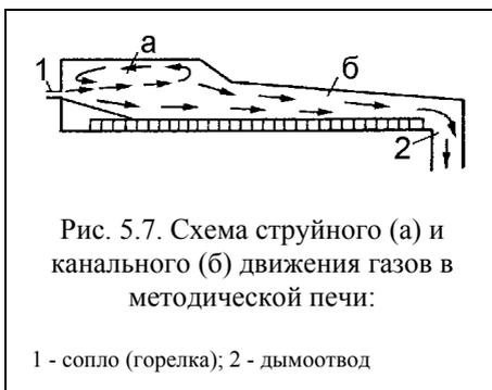
Рис. 5.7. Схема струйного (а) и канального (б) движения газов в методической печи:
