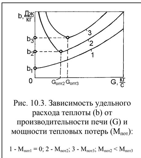
Рис. 10.3. Зависимость удельного расхода теплоты (b) от производительности печи (G) и мощности тепловых потерь ( $M_{\text{пот}}$ ):
