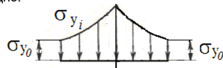
Рисунок 1 – епюри контактних нормальних \sigma_y напруг за Є.П. Унковим
