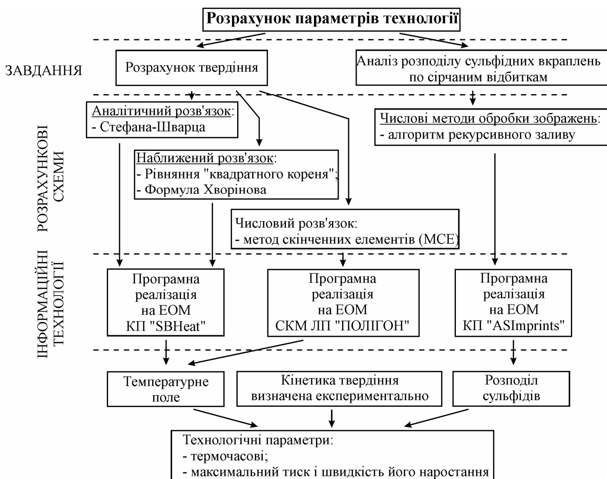
Рис. 1. Схема, що ілюструє загальну методику визначення технологічних параметрів на прикладі сталевго виливка
