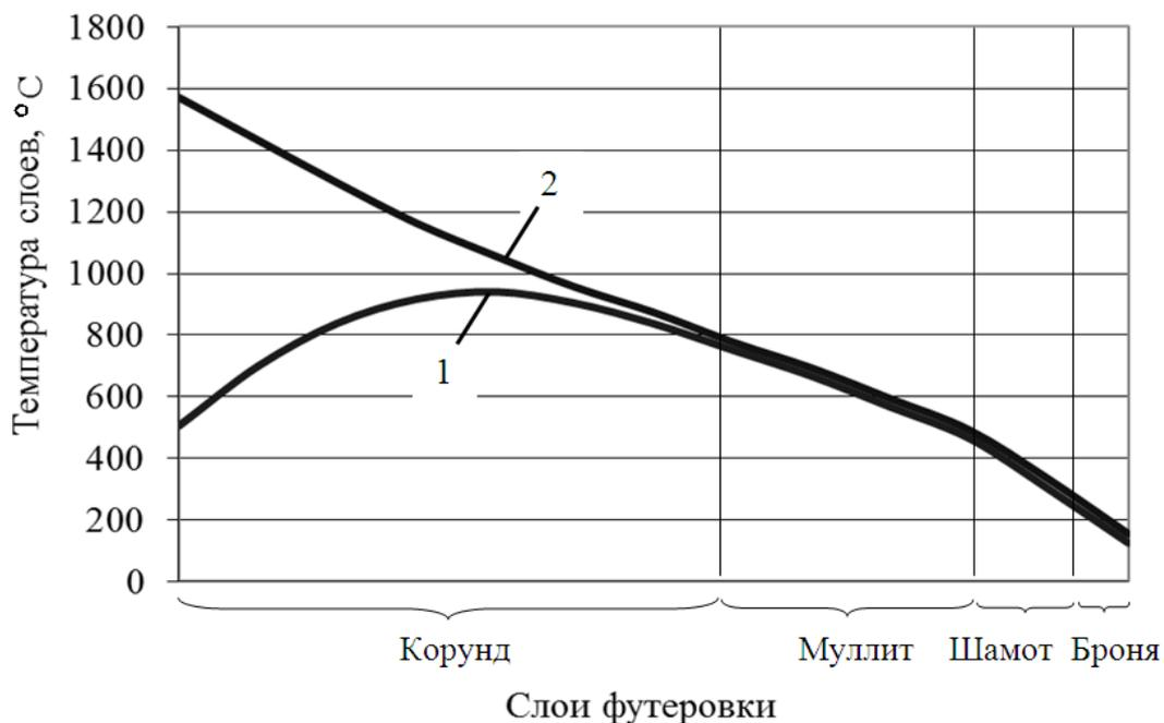
Рис. 2. Результаты моделирования динамики теплового состояния остывшего ковша
