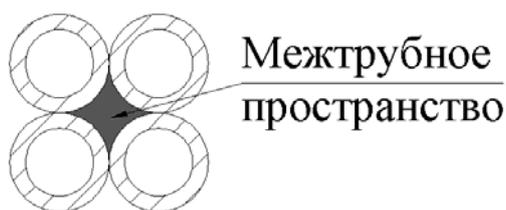
*Рис. 2. Элемент поперечного сечения трубной насадки*
