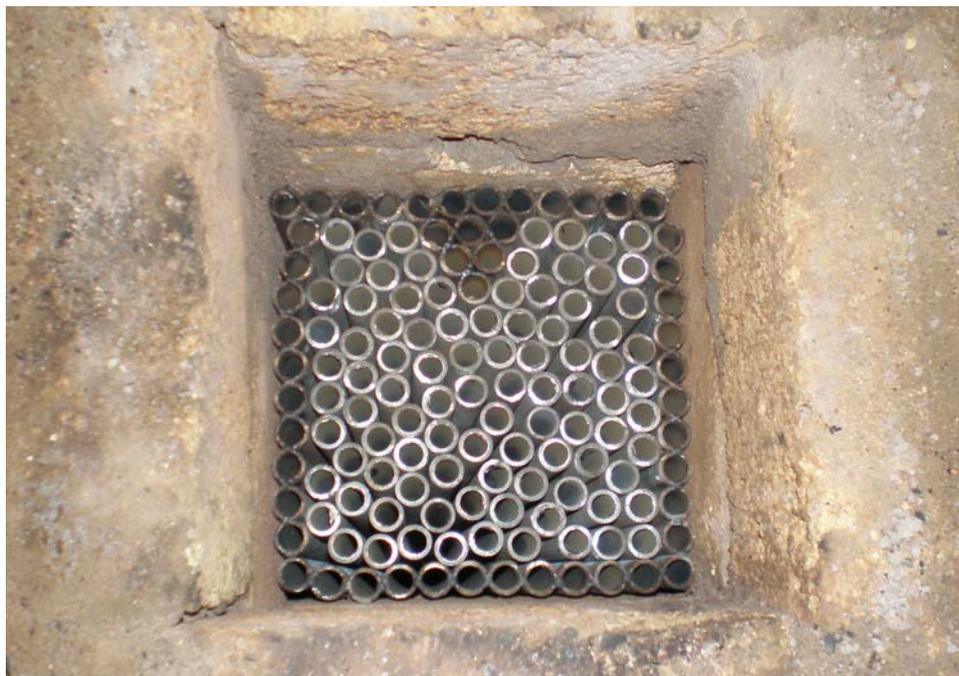
*Рис. 3. Насадка из металлических трубок (вид сверху)*
