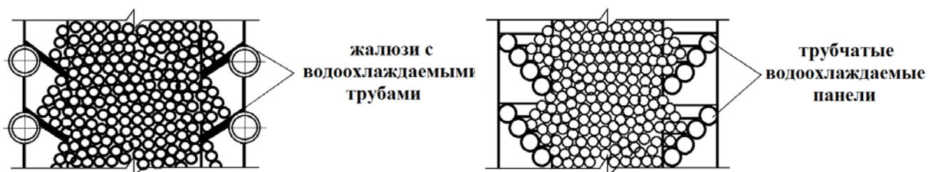
Механизм осаждения пыли в зернистых фильтрах представляет собой сочетание касания, зацепления, отсеивания, гравитации, инерции и электростатики.
