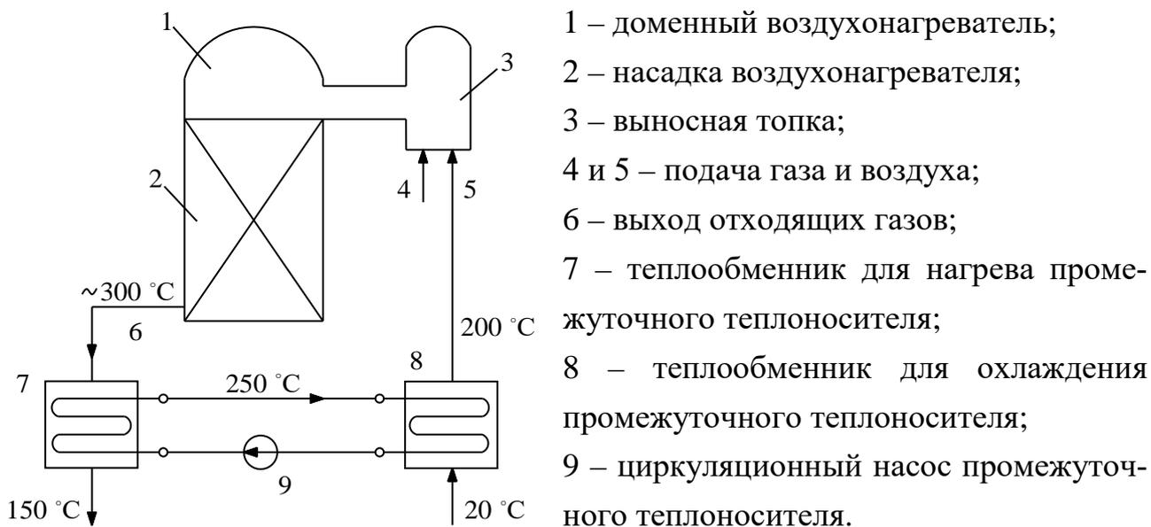
Рисунок 1.7 – Схема использования теплоты отходящих газов доменных воздухонагревателей
