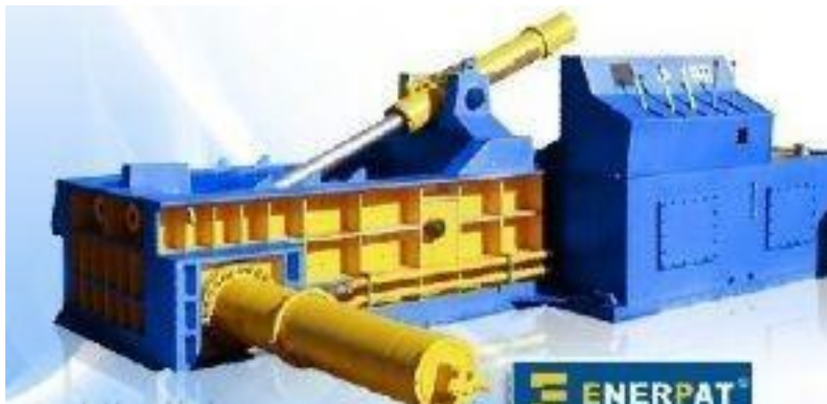
Рисунок 7 – Гідравлічний брикет-прес типу ENERPAT SMB-F250B [9]
