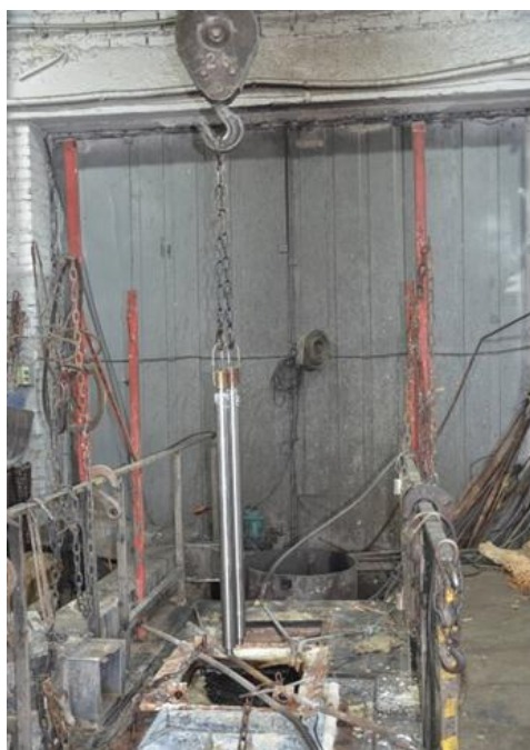
Рисунок 10 - Карбонітрація трубопресового інструменту на ТОВ «Карбаз»
