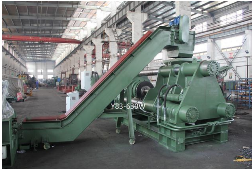
Рисунок 6 – Гідравлічний брикет-прес типу Y83-630 [8]
