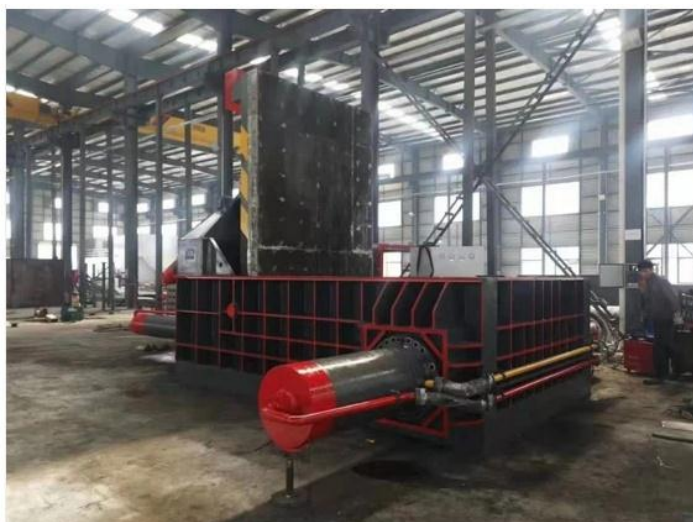
Рисунок 8 – Гідравлічний прес-пакувальник серії TITAN Y81 та готовий брикет [10]
