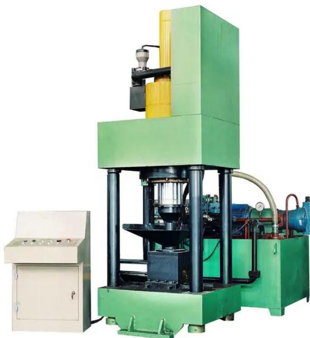
Рисунок 1 – Брикет-прес для металевої стружки типу Y83-315 [3]
