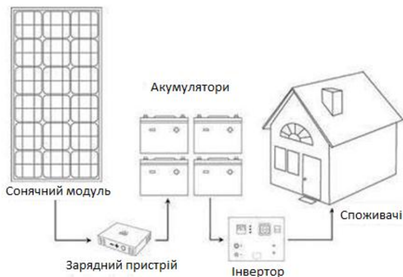
Рисунок 1 – Блок схема складу устаткування сонячної електростанції
