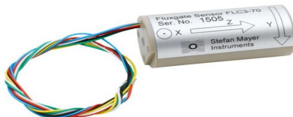
Рисунок 6 – Загальний вигляд феррозонда FLC3-70
