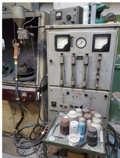
Рисунок 4 – Плазмотрон ПП-25 і установка УПУ-3 з плазмотроном ПП-25 і порошковим дозатором, зліва (на задньому плані) камера для наповнення з вертикальним обертачем, [20]
